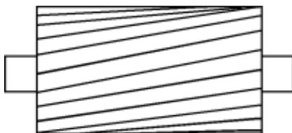
As barras condutoras da gaiola são colocadas geralmente com certa inclinação, para evitar as trepidações e ruídos que resultam da ação eletromagnética entre os dentes das cavidades do estator e do rotor.
