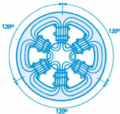
Na figura ao lado é mostrado um “enrolamento trifásico”, que é composto por três monofásicos espaçados entre si de 120 graus. Se este enrolamento for alimentado por um sistema trifásico, as correntes I1, I2 e I3 criarão, do mesmo modo, os seus próprios campos magnéticos H1, H2 e H3. Estes campos são espaçados entre si de 120 graus. O campo total H resultante, a cada instante, será igual à soma dos três campos H1, H2 e H3 naquele instante.
