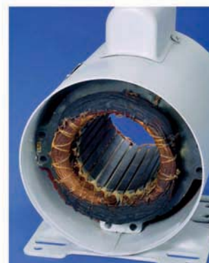
SOBREAQUECIMENTO NO ENROLAMENTO PRINCIPAL
