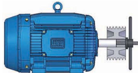
Figura 13.6 - Dispositivo para montagem de polias quando existe furo roscado na ponta do eixo.
