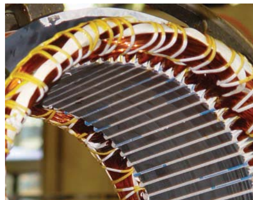
Fig. 1.12 – Fios e Filmes aplicados no estator
