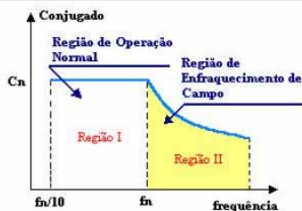
Figura 1.4 - Característica do conjugado x rotação do motor CC
