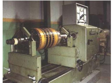
Paralelamente deverá ser verificado o balanceamento do conjunto do rotor e o estado dos mancais. Se necessário, averiguar o tempo de vida útil, tipo de graxa, quantidade e intervalos de lubrificação do rolamento (conforme especificações do fabricante).
