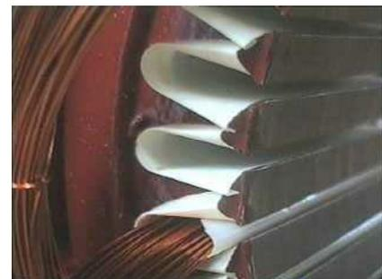
Estando tudo Ok, após a colocação de todas as bobinas, providencie a fixação das cabeceiras das bobinas no lado contrário ao dos terminais, utilizando fibra isolante entre os grupos de bobinas e fita ou cadarço isolante para amarração das mesmas.
