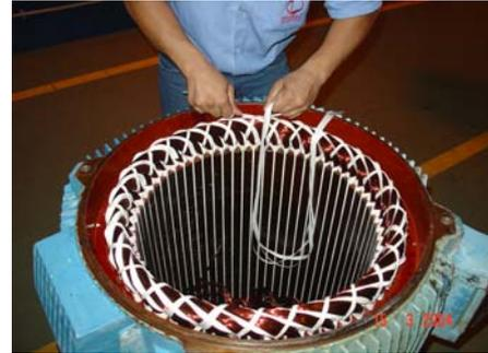
A etapa seguinte é a identificação dos grupos de bobinas pertencentes a cada enrolamento e sua respectiva interligação. As emendas devem ser efetuadas com o uso de solda e isoladas com tubo isolante (espaguete) que possua classe de isolamento compatível. Não se esqueça de providenciar a retirada do verniz que recobre o fio antes de efetuar a soldagem.
