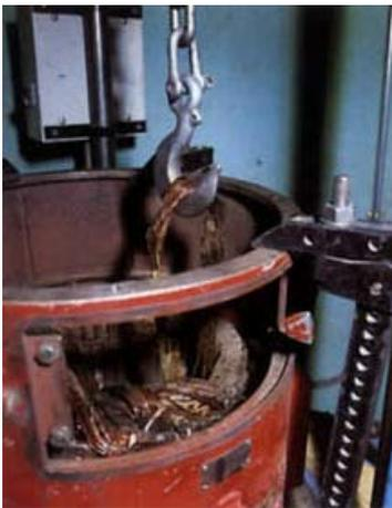
Após esta etapa, inicie a retirada do enrolamento. Não exerça grandes esforços mecânicos sobre o pacote de chapas magnéticas. O aquecimento do bobinado facilita a retirada dos fios sem danificar o estator. O mesmo nunca deve ser feito a base de fogo ou maçarico. Poderá ser usado aquecimento por estufa com temperatura controlada, não ultrapassando 150° C.
