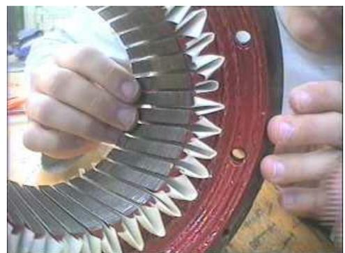
A disposição das bobinas deverá seguir o diagrama planejado construído inicialmente, segundo o projeto original. A identificação de cada grupo de bobinas poderá ser feita no momento da sua colocação ou após todos os grupos
