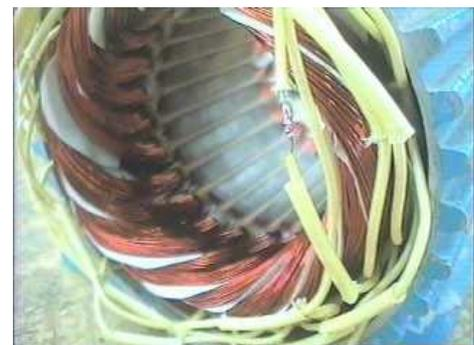
Providencie a amarração final, da mesma forma que foi feita no lado oposto, colocando uma fibra isolante entre os grupos de bobinas e ajeitando as emendas e fios terminais na cabeceira das bobinas, evitando os cruzamentos.
