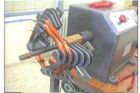
Antes de iniciar a colocação das novas bobinas, providencie novas fibras isolantes para as ranhuras, respeitando as medidas originais e a classe de isolamento do motor.
